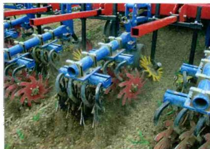
**La sarceuse à socs peut être combinée à la houe rotative. (Photo d'usine)**
