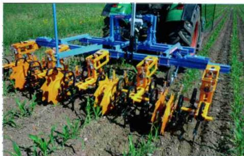
**La sarcluse de Schmotzer dispose de socs «patte d'oie» sur parallélogramme. (Représenté par GVS-Fried AG, Koblenz).**
