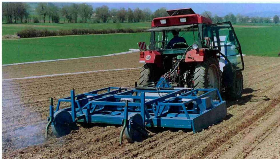
**En maraîchage, le traitement thermique intégral en prélevée est très utilisé, en particulier sur les carottes. Appareil de désherbage « StffG1.5/3.05G » (Schaffner Terra Tech SA, Oensingen).**
