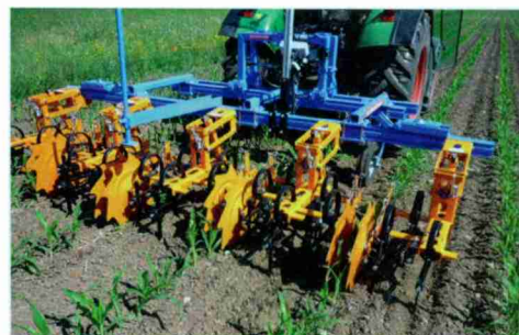
Schmotzer Scharhacke für Heckenbau: Die Zahnschutzrolle ist jeweils am Parallelogramm befestigt und lässt sich hochklappen, wenn die Pflanzen genügend gross sind. (Vertretung GVS-Fried AG, Koblenz)
