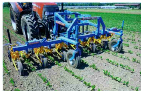
Das Schmotzer Scharhackgerät gibt es für den Frontanbau. (Vertretung GVS-Fried AG, Koblenz)
