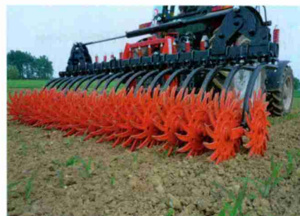
Der Moro Krustenbrecher hat mit 8–12 km/h eine hohe Flächenleistung. (Vertretung GVS-Fried AG, Koblenz)
