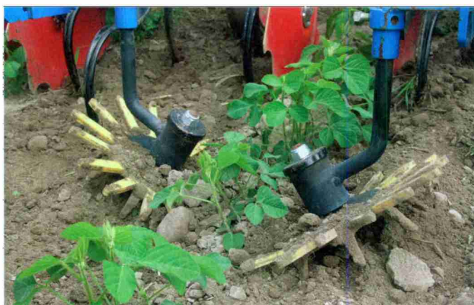
Die Fingerhacke erfasst das Unkraut auch in der Reihe. (Vertretung, Fobro-Kress in Hüswil und Althaus AG in Ersigen)
