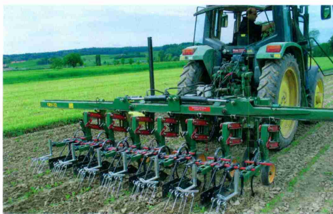
Thyregod-Scharhackgerät mit Kamerasteuerung. (Vertretung, Daniel Wyss, Landtechnik, Ruppoldsriet)
