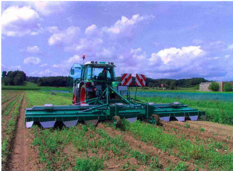
Abflammen von Kartoffelstauden (Modell STFFG7.5LG, Schaffner Terra-Tech AG, Oensingen, 7,5 m Arbeitsbreite, Gasverbrauch 100 kg/h, Geschwindigkeit 2–5 km/h, Gewicht 1400 kg). (Bild zVg)
