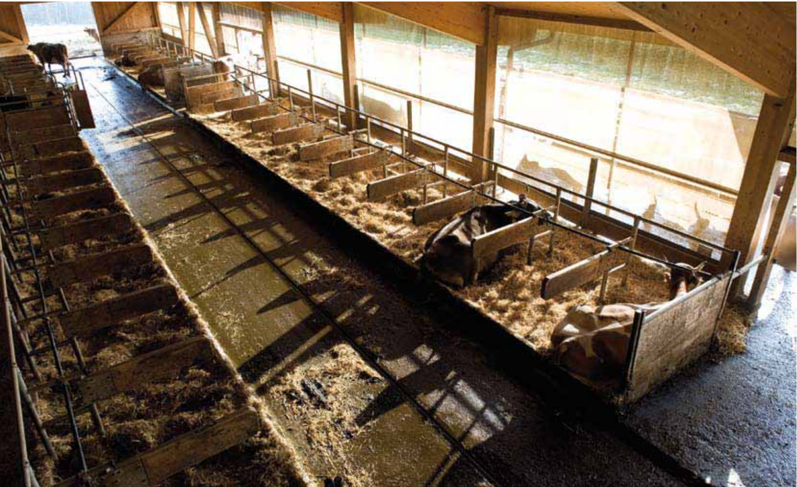
Eine der wichtigsten stallbaulichen Voraussetzungen für eine ruhige, ausgeglichene horntragende Herde ist die klare Aufteilung der Bereiche fürs Fressen, Liegen und Bewegen. Auch genügend Platz im Warteraum kann entscheidend sein. Im Bild der Laufstall des Herterenhofes bei Wettingen AG (vgl. Seite 7).
