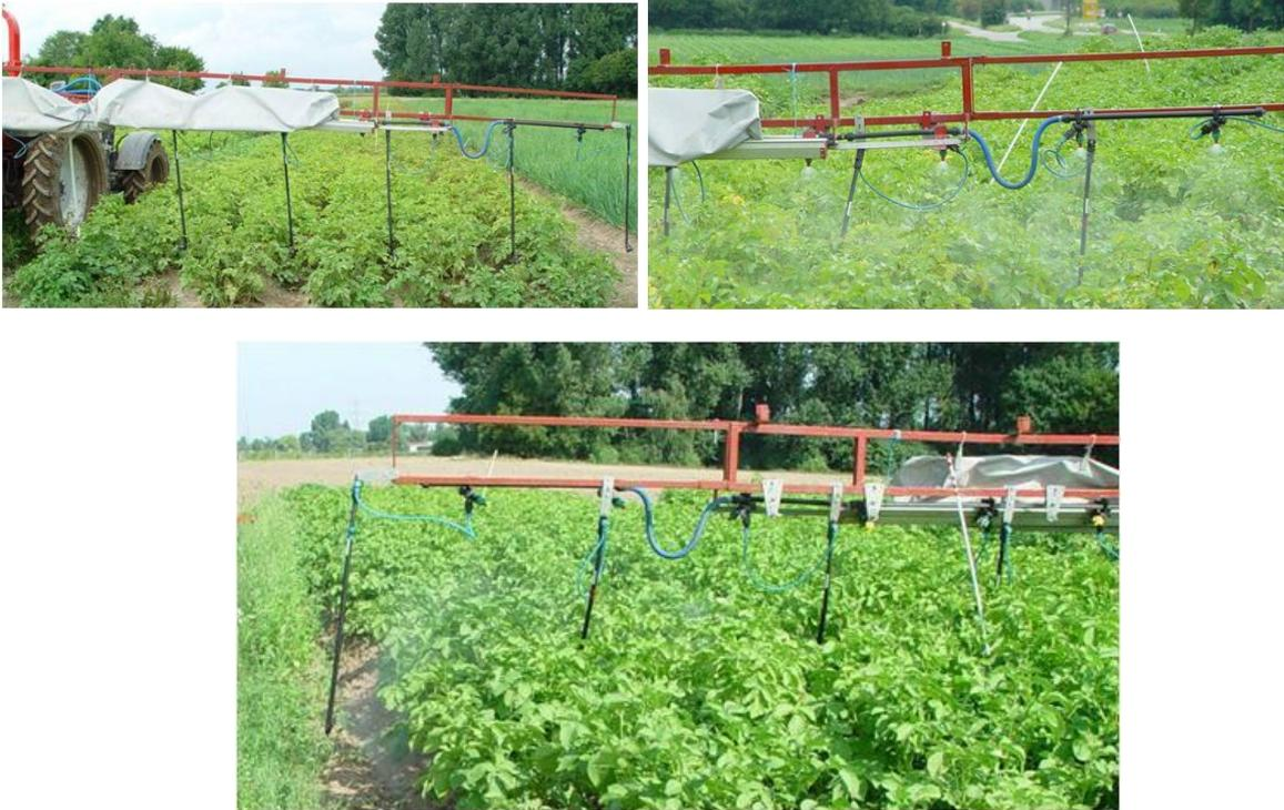
**Abb. 11 Applikationsverfahren in den Kartoffelversuchen, Sorte Agria, 2011 und 2012 auf dem Queckbrunnerhof, Schifferstadt (DLR Rheinpfalz): Dropleg-Applikation (links oben und unten), Spritzbalken - Dropleg-Applikation (rechts oben)**
