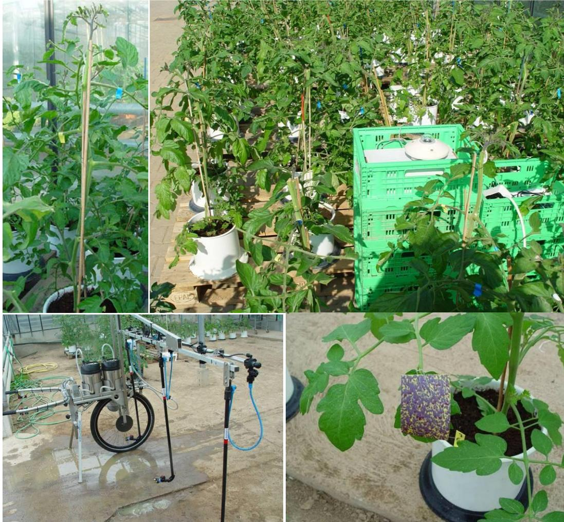
**Abb. 1 Anlage der Semifreilandversuche: Containertomate, Sorte Campari, mit markierten Blattetagen (links oben) und Versuchsanlage mit Solarimeter zur Messung der Globalstrahlung (rechts oben), Fahrradspritze (Schachtner) (links unten) und Montage von wassersensitivem Papier (rechts unten)**
