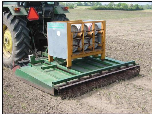
Billede 2. Gasbrænding af ukrudt i majs med fladebrænder i høj solskin.
