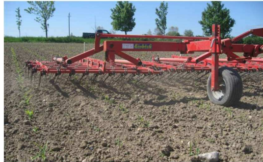
Billede 5. Strigling i rækkeafgrøder er oplagt at gøre før såning, i form af falsk såbed.
