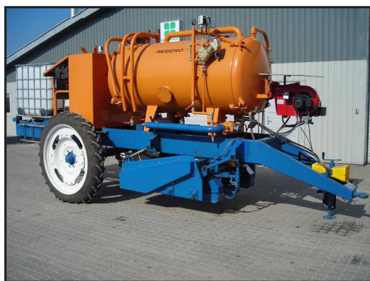
Billede 2. Dampmaskine til rækkedampning, en investering i sparet arbejde.
