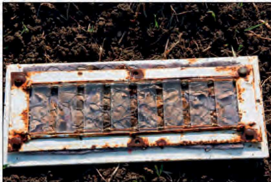
Billede 3. En "sporefælde" er ganske enkel. Her ligger gamle æbleblade med skurvinfektion klemt fast af hønsevæv. Ovenpå ligger objektglas. Når det regner/vander vil sporerne springe fra bladet og op i luften. Sporerne er lidt klæbrige og vil hænge fast i glassets underside. Efter bygen/vandingen samler man glassene ind og tæller sporerne under mikroskop.
