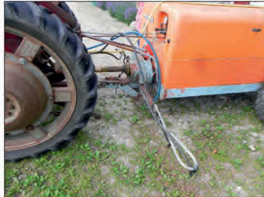
Billede 2. Vandvognen hos Poul Rytter Larsen er en ombygget tågesprøjte. Kompressoren er fjernet og i stedet påsat en spredébom. Den gjorde et godt stykke arbejde og var rel. billig, ca. 8000 kr alt i alt.
