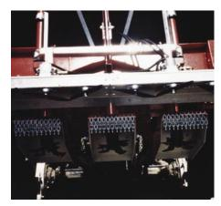
Bei einem Reihenabstand von 50 Zentimeter werden 30 Zentimeter gemulcht. Die Messer drehen mit 5000 U/min.
