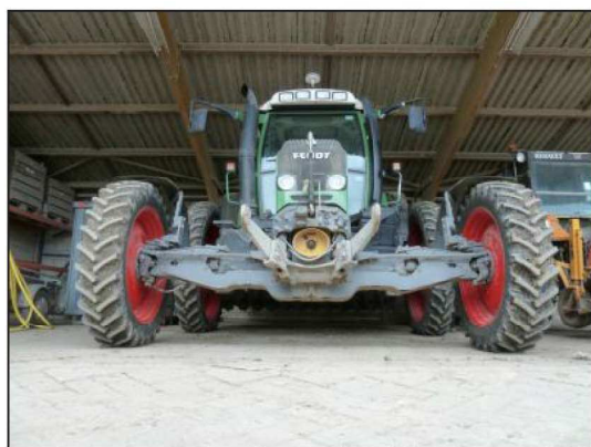
Billede 2. Sporvidden på traktoren skal typisk tilpasses mejetærskerens sporvidde.
