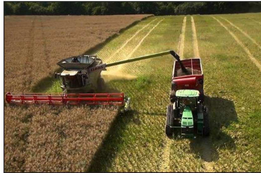
Billede 1. Et 12 meter CTF system kræver en lang tømmebegl på mejetærskeren.
