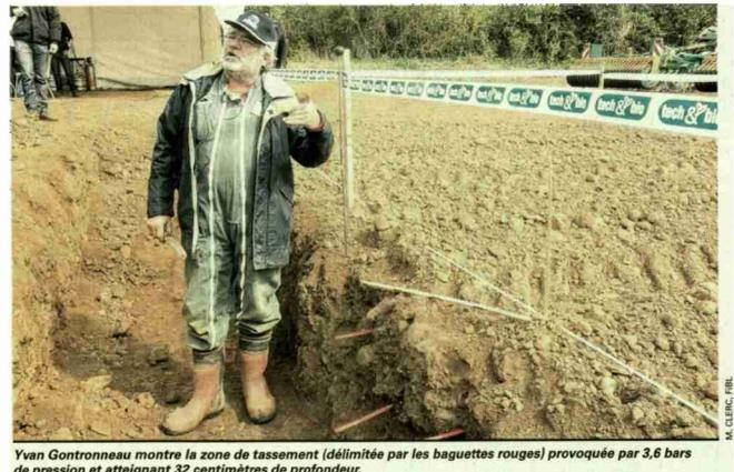
Yvan Gontronneau montre la zone de tassement (délimitée par les baguettes rouges) provoquée par 3,6 bars de pression et atteignant 32 centimètres de profondeur.
