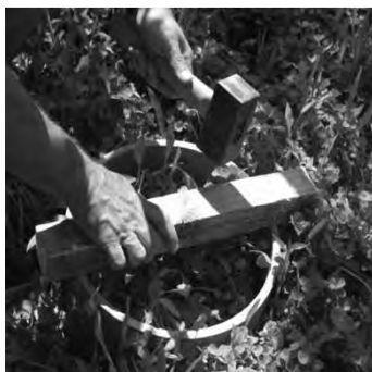
2. Enfoncer le cylindre PVC dans le sol (1 à 2 cm) après avoir scalpé ou coupé à ras la végétation
