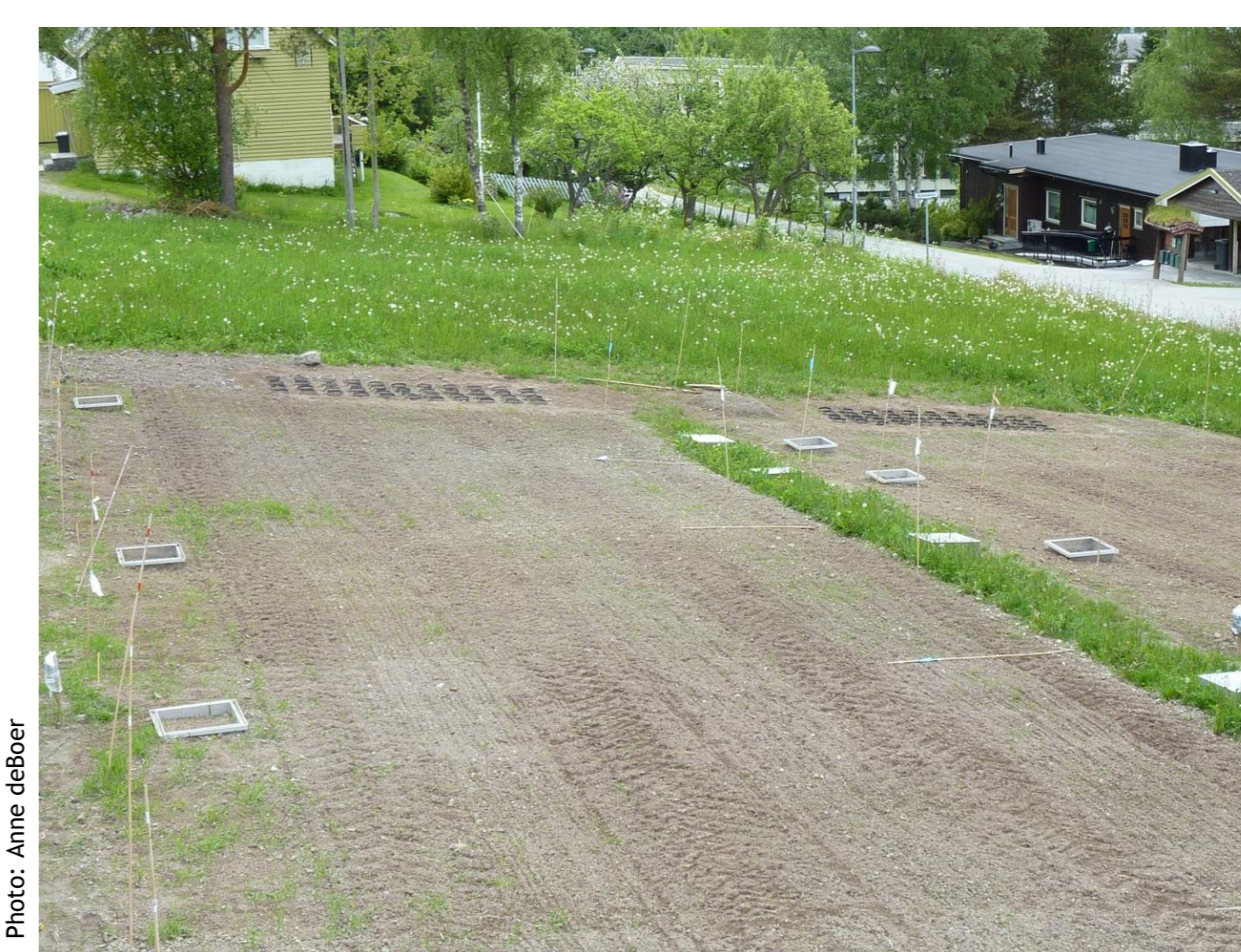
Figur 7. Forsøksfeltet med kasser for gassmåling.
