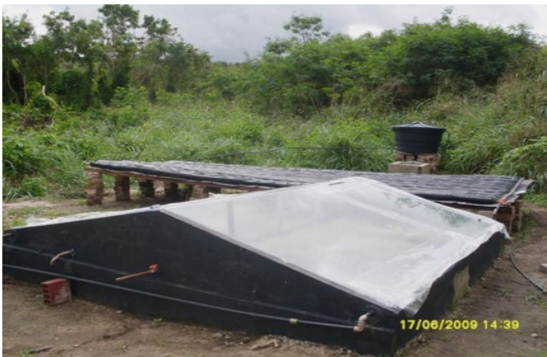
Figura 1: Caixa de alvenaria para evaporação/condensação da água após o aquecimento no coletor solar
