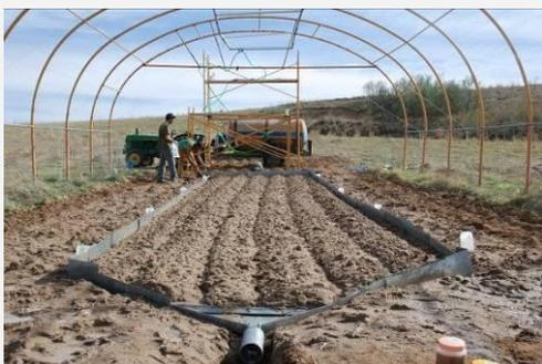
Estructura para estudios de erosión hídrica con lluvia artificial
