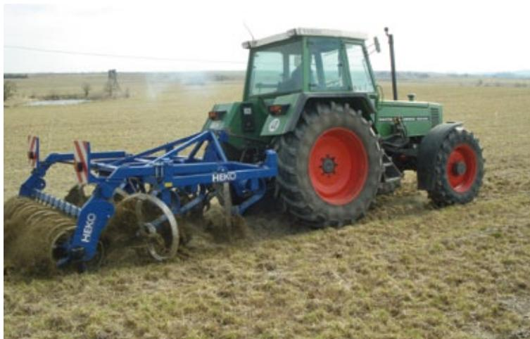
Foto 1: Anwendung der ganzflächig durchtrennenden Flachbodenbearbeitung zur Bestandsabtötung von Luzerne-Klee grasbeständen (Foto: Ralf Bloch)
