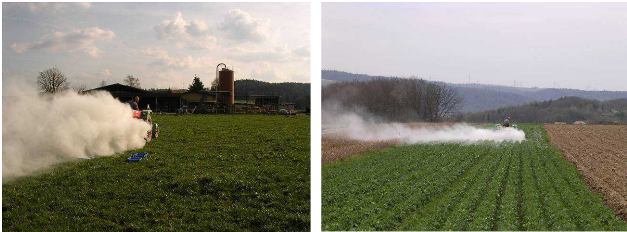
Abbildung 2: Mit dem Düngestreuer Rauch MDS 65 (links) konnten nur 2-3 m Streubreite erreicht werden. Die Streuwolke entwickelt sich dabei hoch. Der Vicon-Pendelstreuer (rechts) weist nur eine relative flache Streuwolke auf. Ohne Windschutz ist das Streubild unsymmetrisch 4-6 m breit.
