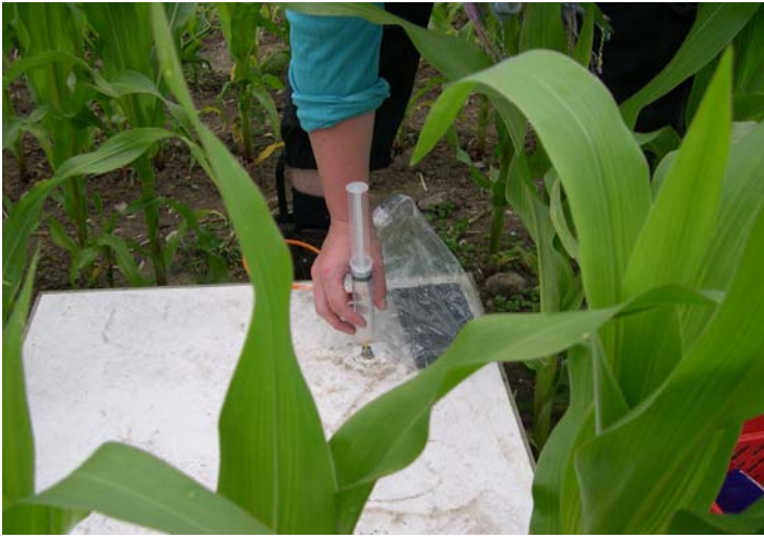
Udledningen af N_2O blev målt ved hjælp af manuel gasprøvetagning i gas-flux kamre.
