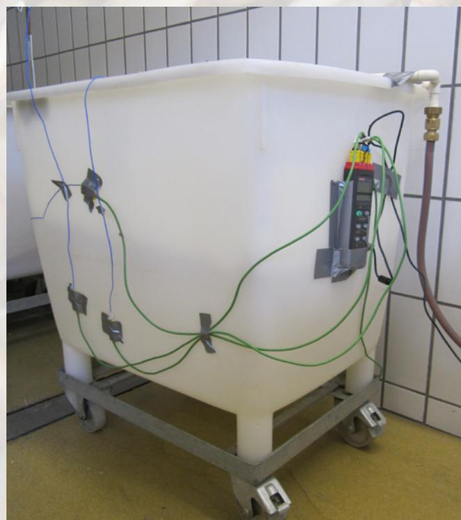
Abbildung 10: Messgerät an der Versuchswanne (Märkisches Landbrot)
