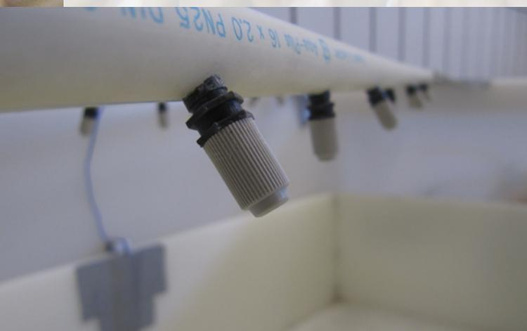
Abbildung 9: Wasserdüsen an der Berieselung (Märkisches Landbrot)
