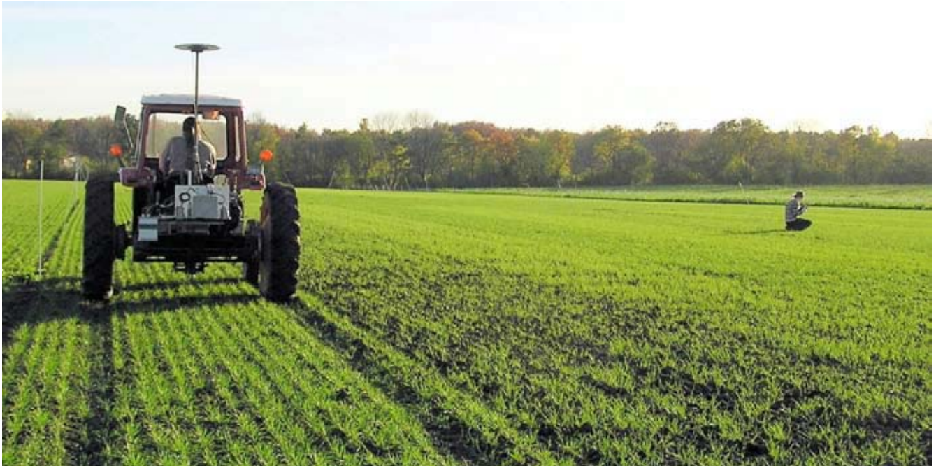
Automatisk kortlægning af afgrøde og ukrudt ved hjælp af sensorer, billedbehandling og GPS (til venstre) og manuel optælling af ukrudt (til højre).
