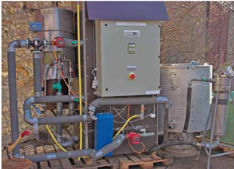
**Bild 1:** Heißwasserbeizanlage der LBS Dfthof: links: Feuerung, Mitte: Temperatursteuerung, rechts: Tauchbecken
