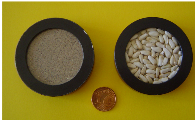
Abb. 1: Küvetten für die NIRS-Messungen, links befüllt mit Mehl, rechts befüllt mit unvermahlenden Achänen
