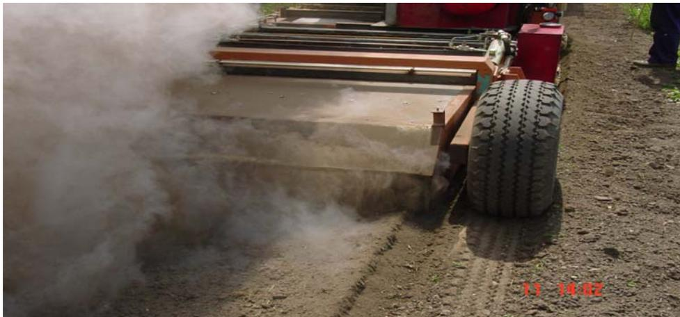
Abb. 4: Thermokammer, in der die Bodenpartikel mit Hilfe der Umkehrfräsen geschleudert werden und somit hohen Temperaturwerten ausgesetzt sind
