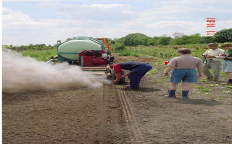
Abb. 7: Überprüfung der Eindringtiefe der Bodenfräse und der Bodentemperaturwerte
