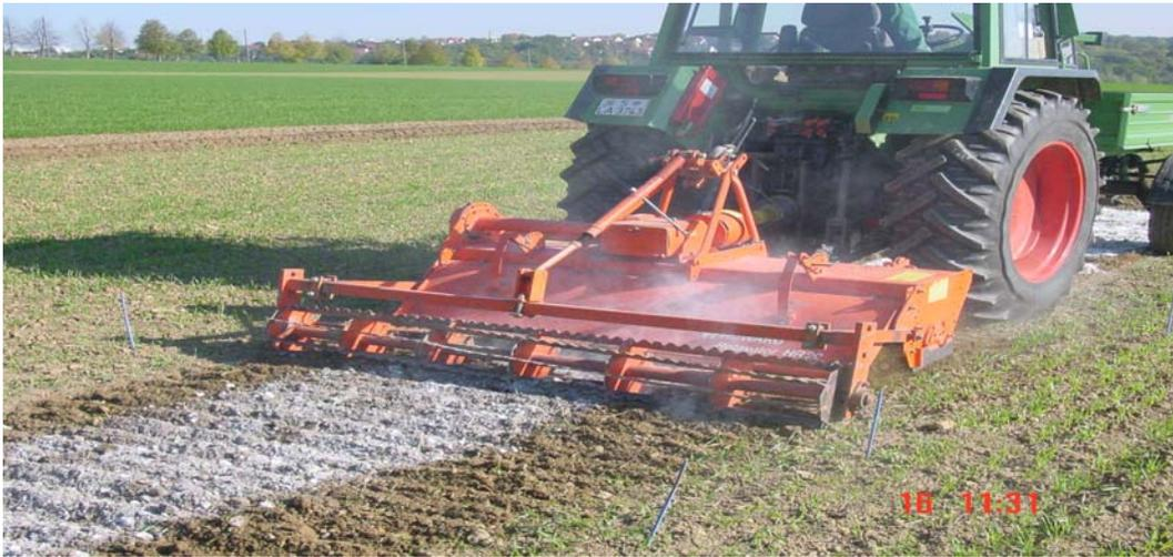
Abb. 13: Fräsen der Versuchsflächen bis ca. 15 cm Bodentiefe zur „Realkalisierung“ des Bodens
