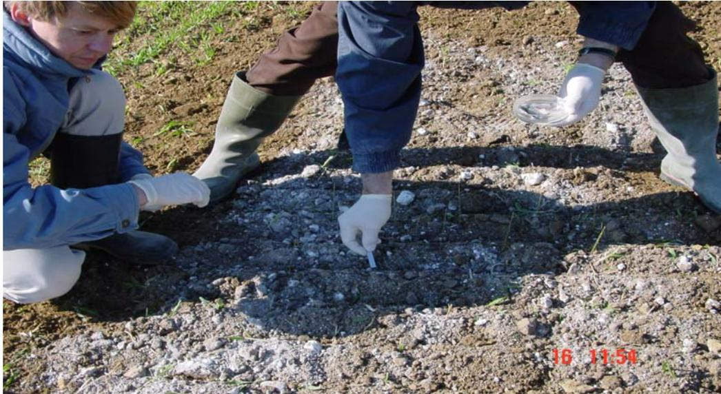
Abb. 12: Einbringung der mit den „Prüfkeimen“ kontaminierten Keimträgern in ca. 5 cm Bodentiefe der jeweils gekalkten Versuchsflächen
