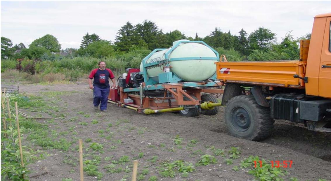
Abb. 1: „BVS-Bodensanierungsgerät“ mit Zugmaschine in Vorbereitung zum praktischen Einsatz
