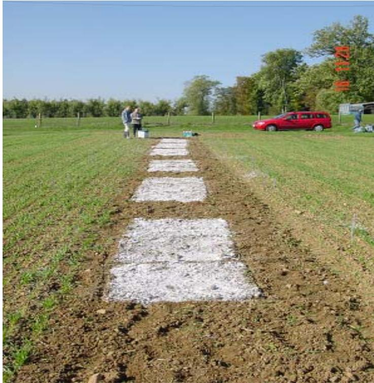
Abb. 11: 6 Versuchsflächen mit Kalk (im Vordergrund  $0,8 \text{ kg CaOH}_2/\text{m}^2$ ; im Hintergrund  $1,6 \text{ kg CaOH}_2/\text{m}^2$ )
