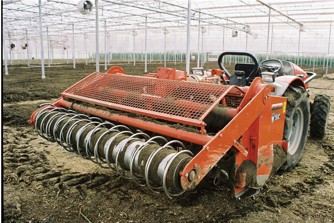
Figuur 2-1: Spitsfreesmachine met harkrol (aandrukrol met spiraalvormige tanden).
