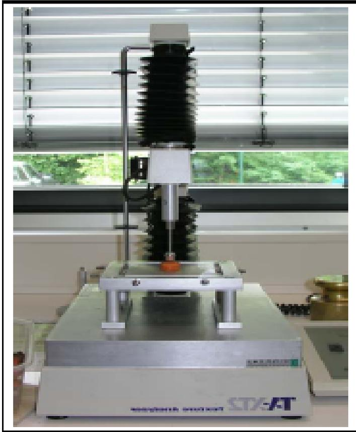
Abb. 7: Texture Analyser mit Kugelsonde (TA.XT2, Fa. Stable Micro Systems)
