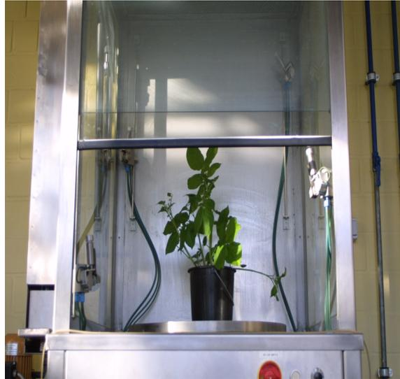
Abb. 1: Applikationskabine mit Drehtisch und 4 Düsen in unterschiedlichen Höhen
