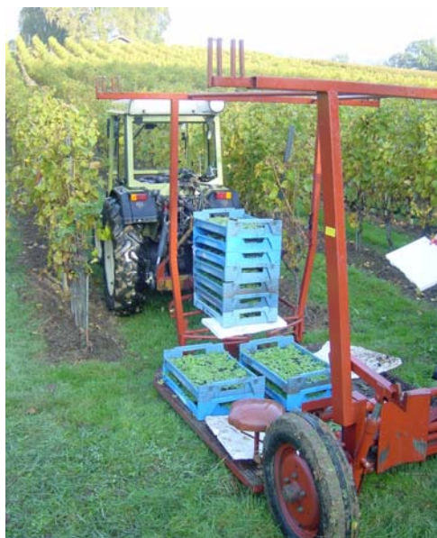
Ernteplattform zur einfacheren Pflanzung der Setzlinge (Fotos: P. Monnard)
