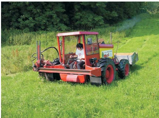
Abb. 3: Maschinelles Ampferstechen in Trenthorst mittels des in Österreich entwickelten Prototyps „Wuzi“
