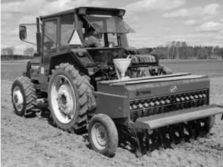
Figur 1. I projektet används en kombisåmaskin som har modifierats för att klara såväl kornad konstgödsel som vinass.
