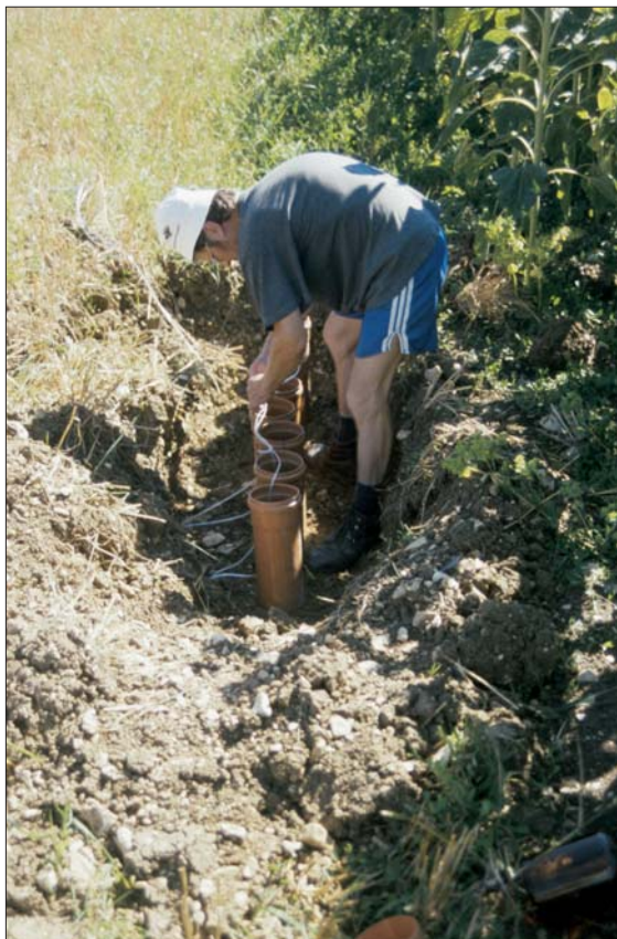
Les sols sabo-graveleux de la plaine d'alluvion du Klettgau sont très perméables et donc fortement menacés par le lessivage. Contrôle des résultats: vérification de l'efficacité des mesures à l'aide de bougies filtrantes.
