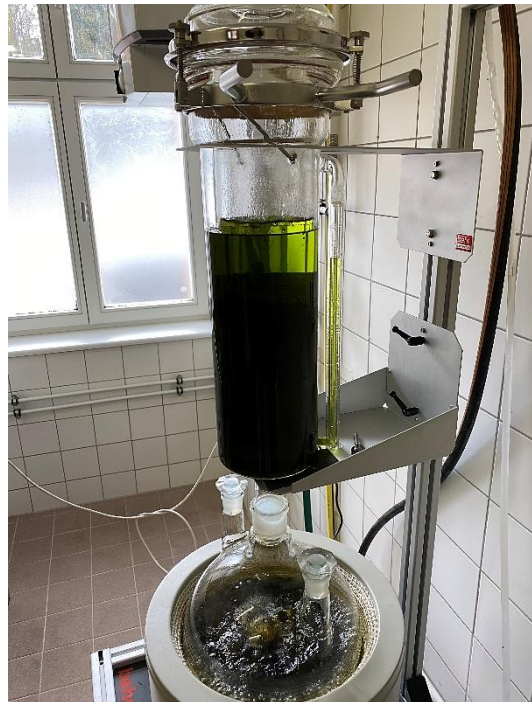
Abbildung 3: Soxhlet-Extraktion am Beispiel der Basilikumernterückstände.
