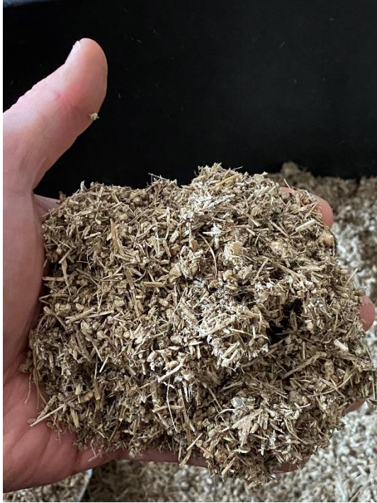
Abbildung 2: Vermahlung der vorzerkleinerten Ernterückstände.
