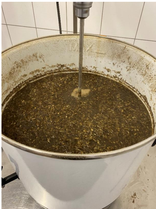
Abbildung 6: Mazeration im kleintechnischen Maßstab.
