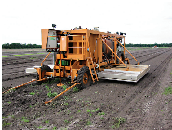
Figur 4.21. Ved fladedampning af grønsagsbede dampes jorden i hele bedets bredde og ned til 10 cm's dybde.
