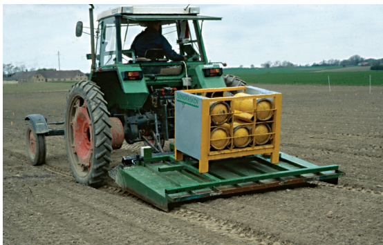
Figur 4.20. Flammebehandling før afgrødens fremspiring.
