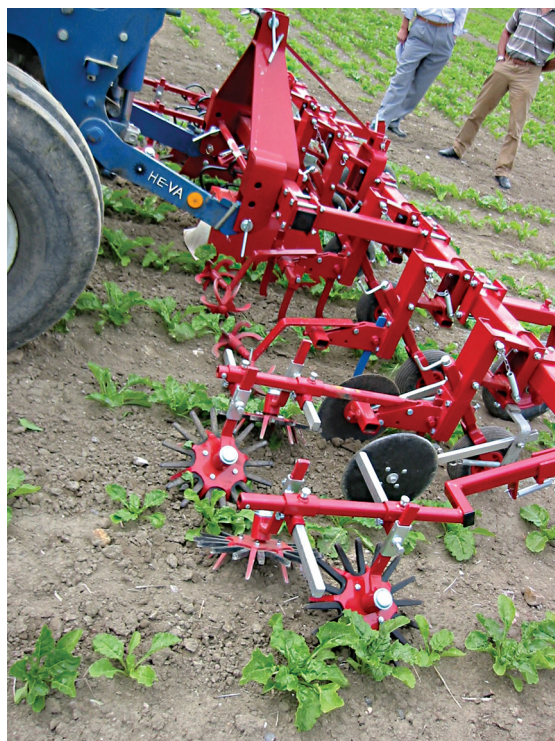
Figur 4.14. Fingerhjul påmonteret en radrenser til bekæmpelse af ukrudt i roerækken.
