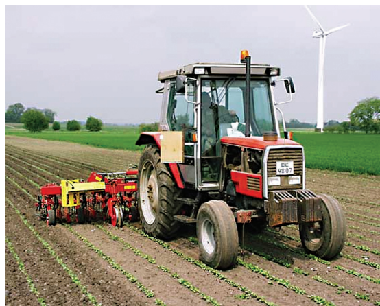
Figur 4.10. Automatisk styring af en radrenser i radiser. Den gule boks på radrenserens ramme indeholder to kameraer til registrering af to afgrøderækker samtidigt. (Foto: Eco-Dan).
