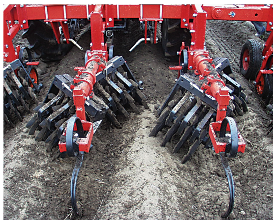
Figur 4.19. Stjerneradrensning mod ukrudt på etablerede kartoffelkamme har vist sig meget effektiv i nye danske forsøg.
