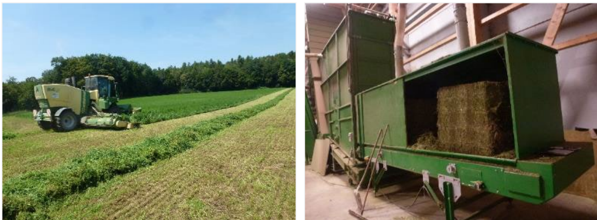
Abbildung 3.2.1-2: Einsatz eines Mähaufbereiters mit Schwadfunktion (links) bei der Luzerneernte; stationäre Separierung der Luzerne in verschiedene Fraktionen in der Futteraufbereitungsanlage in Wechingen (rechts).
