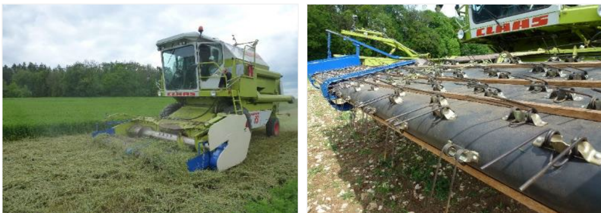
Abbildung 3.2.2-1: Einsatz eines angepassten Mähdreschers zur Ernte von Luzerneblättern (Pick-up im Detail rechts).
