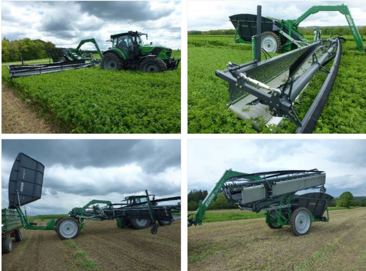
Abbildung 3.2.2-2: Einsatz der Top Cut Collect Maschine der Firma Zürn Harvesting bei der Ernte von Luzernespitzen (oben) mit Ausleeren des Sammelbunkers und vorbereitet für den Straßentransport hydraulisch zusammengeklappt (unten).
