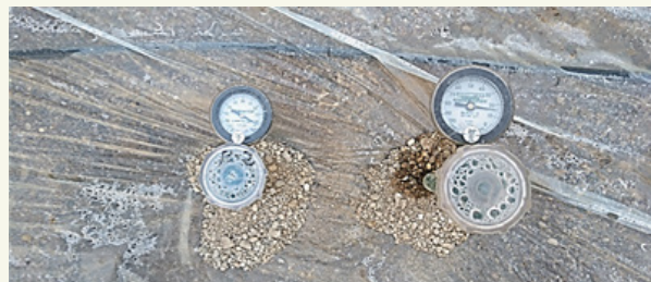
снимка 1: Тензиометри за измерване на влажността на почвата по време на соларизация. Левият е поставен на 15 см дълбочина, а десният на 35 см дълбочина.
