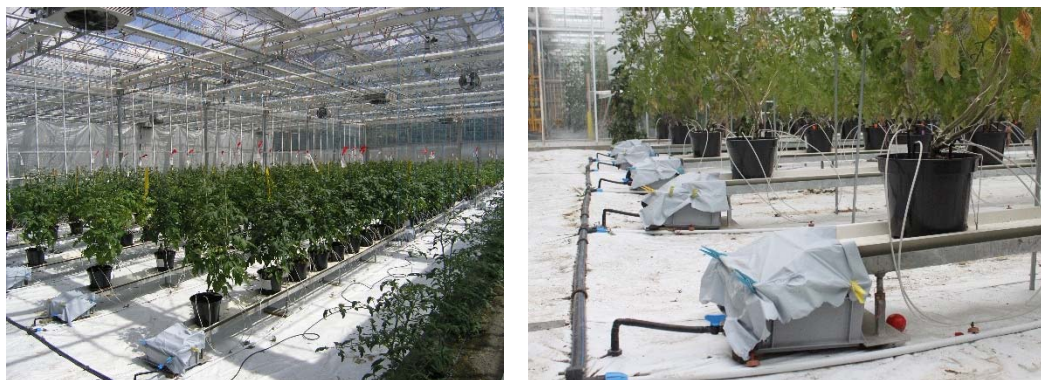
Fig. 1. Mise en place de l'essai Agroscope-Les Fougères 2017 en pots, avec dispositif de récupération du drainage indépendant pour chaque parcelle. (Photo: G. Mottier).
