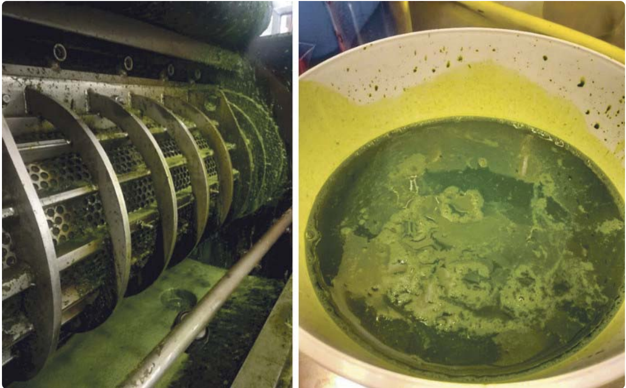
Plantesaft presset ud af frisk høstet Lucerne i en skruepresse i pilotanlæg
