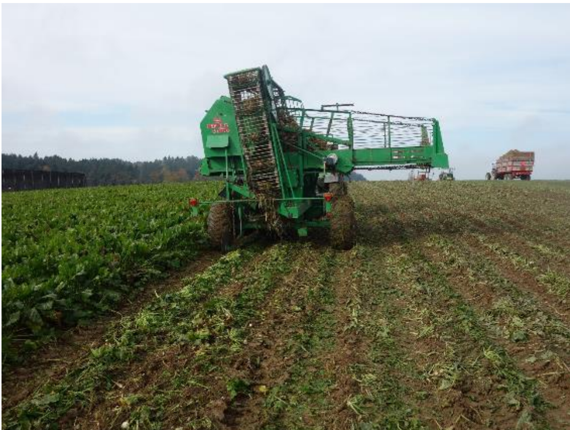
Abb. 12: Aufgrund des feuchten Bodens kann es auch beim Einsatz einer leichten Maschine Fahrspuren geben (Schnottwil, 24.10.2019).
