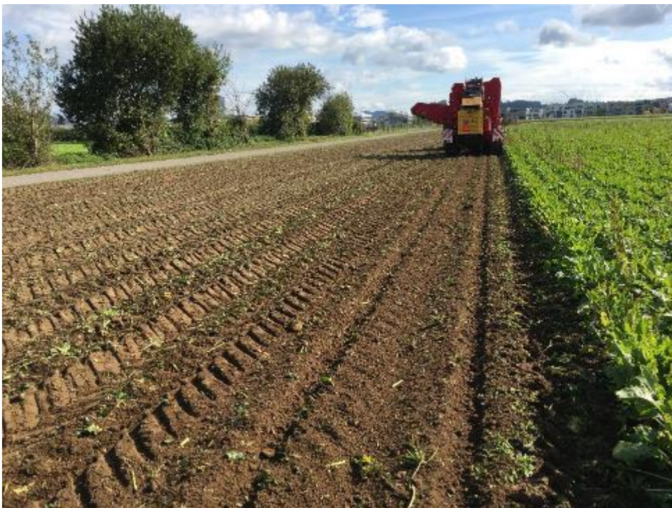
Abb. 20: Beim Roden mit ein- und zweireihigen Maschinen wird ein grosser Teil der Fläche mehrmals überfahren, wodurch die Gefahr von Verdichtungen zunimmt (Schafisheim, 27.09.2019).
