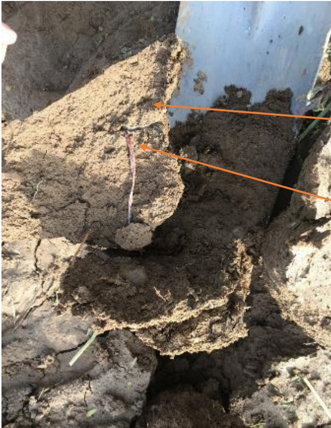
Abb. 3: Blick in den gestörten Boden. Regenwürmer sind aufgrund des Sauerstoffmangels gestorben. Gut sichtbar ist der Sauerstoffmangel auch an den blau-grauen Flecken, welche an verschiedenen Stellen gefunden werden können (27.10.2019).
