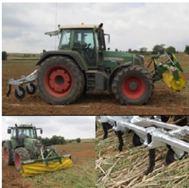
Figura 1. Tractor equipado con el "in-line tiller y roller crimper" (arriba). Detalle del roller-crimper (abajo izquierda) y del in-line tiller (abajo derecha). Fotografías de David Navarro.
