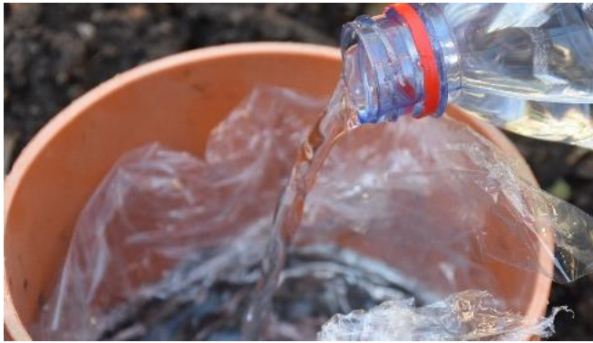
Bild 3: Das abgemessene Wasser wird in den Ring auf die Folie geschüttet. (Foto: Boris Liebl, FiBL).
