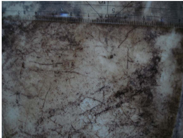
Abb. 6: Feinstwurzelbesatz am Netz mit 80 \mu\text{m} Maschenweite, welches sich an der Innenwandung eines Kunststoffgefäßes befand, in welchem ein künstlich virusinokulierter Baum wuchs (s. mm-Maßstab als Vergleich). Zwischen diesem Netz und dem Wurzelwerk befand sich zusätzlich ein Netz mit 250 \mu\text{m} Maschenweite.
