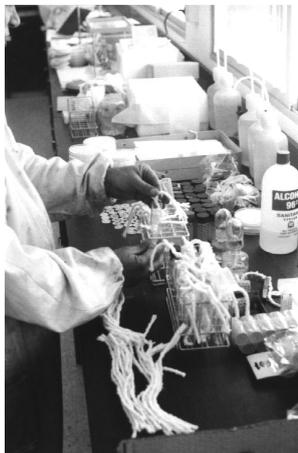
Foto 8. Dosificadores ensayados para la aplicación fácil de tratamientos naturales en colmenas.
