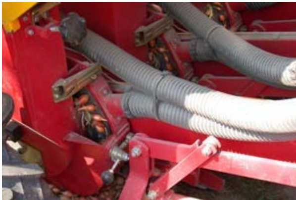
Durch neu entwickelte pneumatische Pflanzmaschinen ist es möglich, Steckzwiebeln in regelmäßigem Abstand abzulegen und dadurch eine gleichmäßigere Kalibrierung des Erntegutes zu erreichen.
