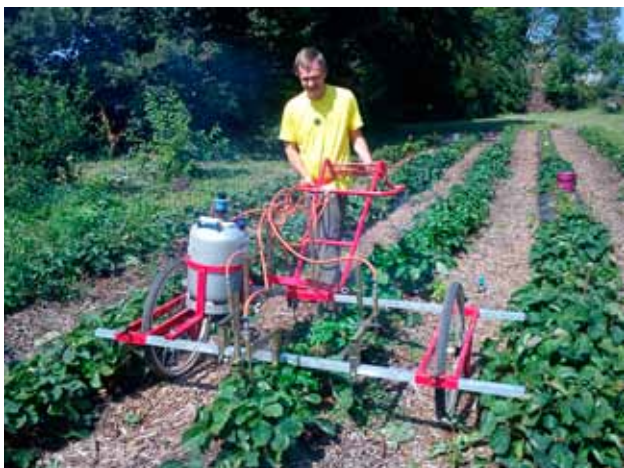
Joonis 5. Maasikalehtede leegitamine firma Elomestar seadmega.
