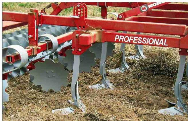
**Wichtig ist eine gleichmässige, flache Bodenbearbeitung mit ganzflächigem Durchschneiden. (Bild: Hansueli Dierauer)**
