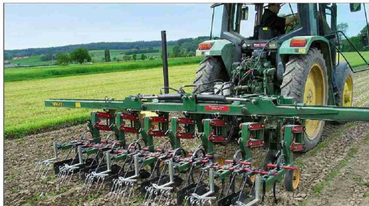
Kameragesteuerte Rübenhacke. (Bild: FiBL)
