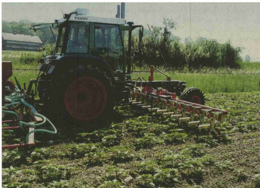
Sonnenblumen lassen sich mit einer Gänsefusscharhacke bei einem Reihenabstand von mindestens 50 cm gut hacken.
