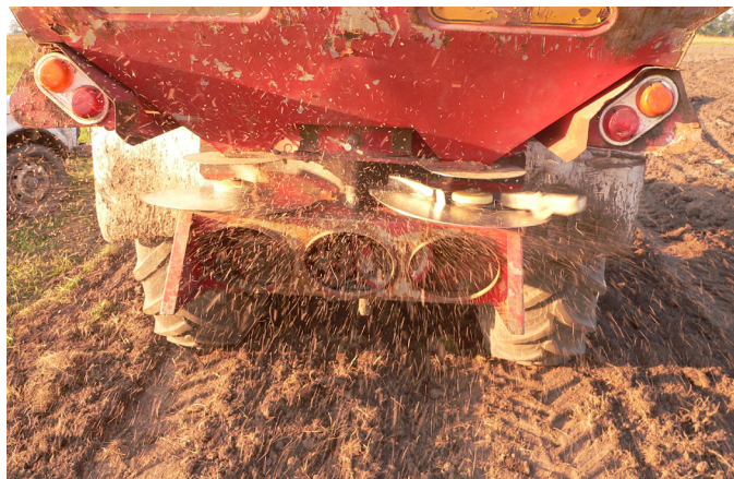
8. kép. Magaszórás függesztett kivitelű, repítő tárcsás műtrágyaszóró segítségével (Deák B. felvétele).
