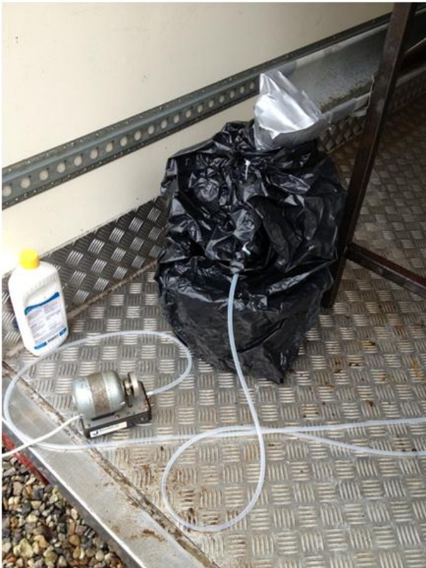
Figur 2: Venstre – opsamling i posesystem med tilførsel af frisk luft. Opsamling i rende, med LED-lys installeret på overkant.
