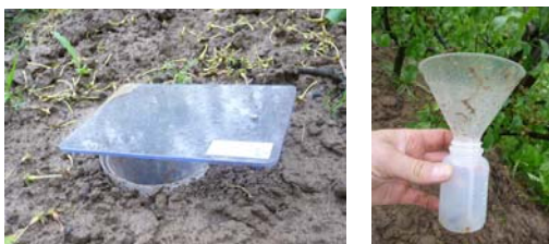
Abb. 3: verwendete Bodenfallen 2009, der Schaft des Trichters ragt in die Plastikflasche, so dass Tiere nicht wieder raus krabbeln können
