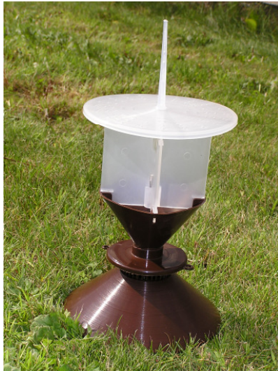
Abb. 2: Pheromonfallen des Typs Yf-Trichterfalle mit Prallfenstern (links) und die damit abgefangenen Schnellkäfer (rechts)
