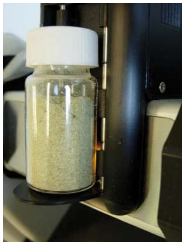
Figur 1. Scanning af formalet prøve med NIRS.
