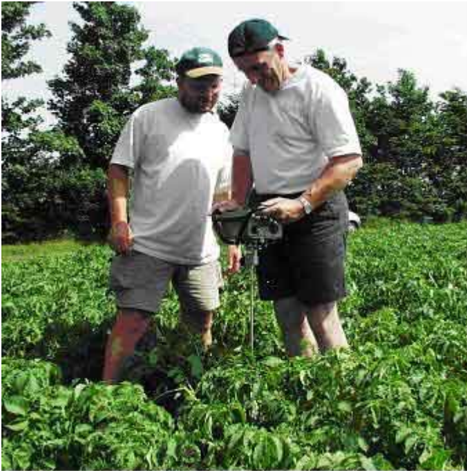
Billede 3. Efter løsningen af jorden blev jordmodstanden målt med et penetrometer.
